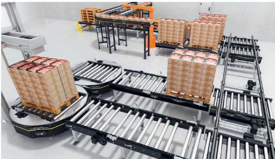
Je nach Kundenanforderung können Systemintegratoren mit der MultiControl ein breites Spektrum an automatisierten Anwendungen realisieren, von autonomen Plug-and-Play-Palettenförderern ohne speicherprogrammierbare Steuerung (SPS) bis hin zu komplexen Anwendungen im Industrie-4.0-Umfeld.
