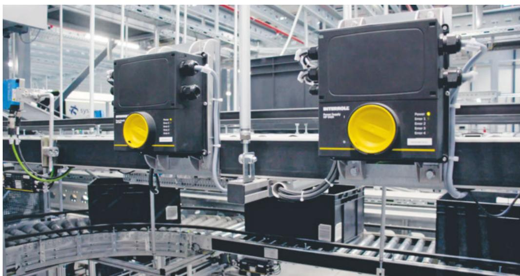
Effiziente Energieversorgung: Die robusten, sofort betriebsbereiten Schaltnetzteile mit IP54-Schutzgrad werden direkt dort montiert, wo die Schutzkleinspannung benötigt wird, und nicht im Schaltschrank. Das ermöglicht viel kürzere Leitungslängen. Das Ergebnis sind sehr kurze Leitungen, die den Strom- und Materialverbrauch senken und Fehler wie einen möglichen Leitungsspannungsabfall reduzieren und einen positiven Beitrag zur Arbeitssicherheit leisten.
